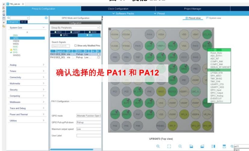
图 7. 使能 sensor 板的 I2C
