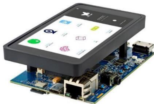
STM32MP1探索套件的边缘处理示例
