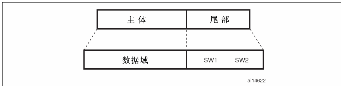
图8 响应APDU结构
