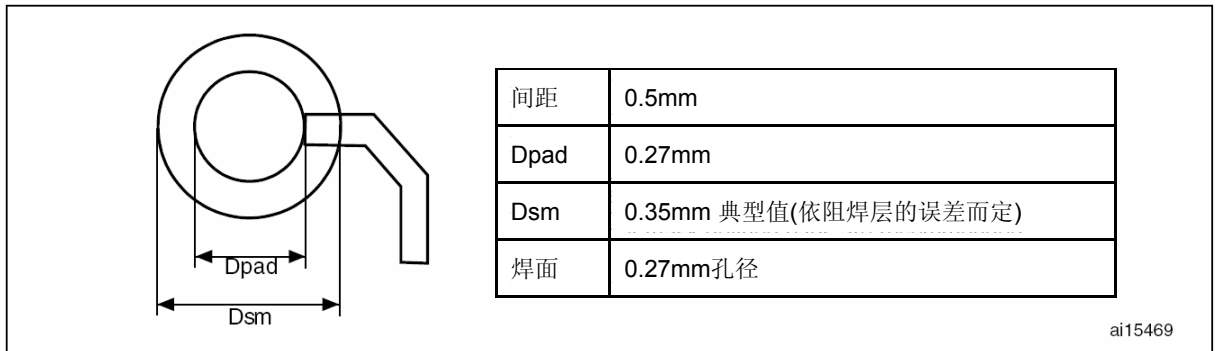
图37 建议的PCB设计规则(0.5mm间距的BGA封装)
