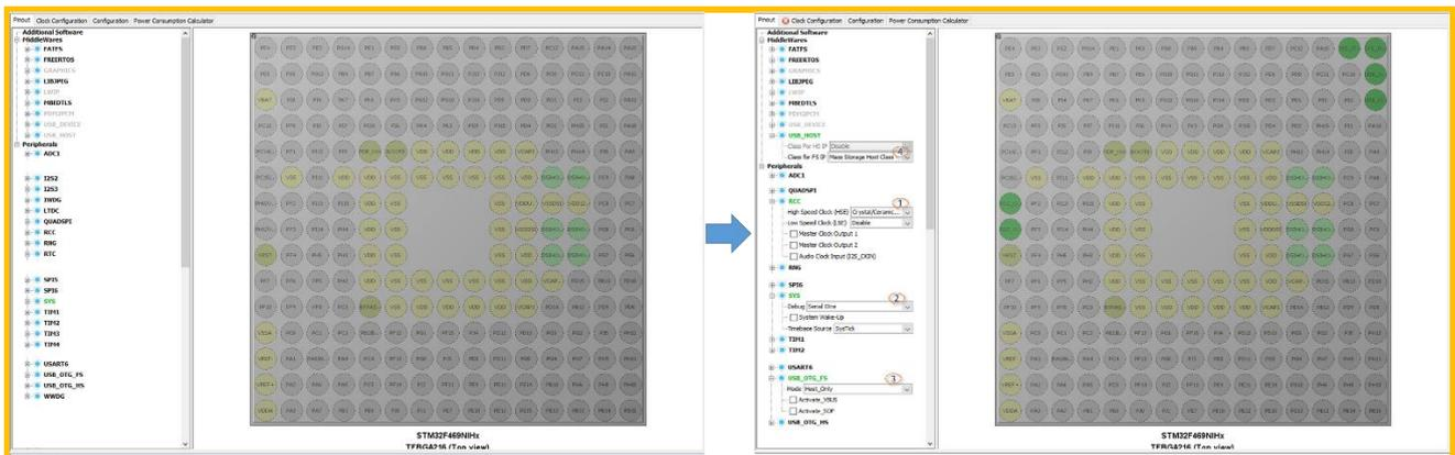
在引脚分布图，PB2 引脚上单击鼠标左键，选择 ‘GPIO\_Output’，如下图所示。
