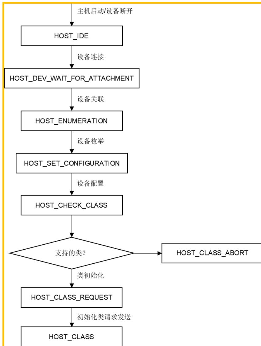
在 HOST\_CLASS 状态中，软核会通知应用类初始化完成。对 U 盘的访问，应放置在应用层接收到类初始化完成事件后，即 HOST\_USER\_CLASS\_ACTIVE 事件后，否则无法正常工作。
