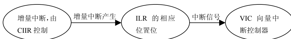
图 5.74 增量中断控制原理示意图
